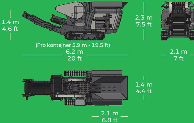
Recyklace stavební suti přímo na stavbě je nejefektivnější metoda, dramaticky snižující náklady na ukládku a odvoz bouraného materiálu a navíc mění stavební sut' v užitečný podkladní produkt. K-JC 604 disponuje drtící komorou o rozměrech 600x400mm a integrovanou vibrační násypkou. Zpracovávaný materiál je neustále konstantní rychlostí posouván do čelistí. Drtící mezera se nastavuje na hydraulicky na dálkovém ovladači.
